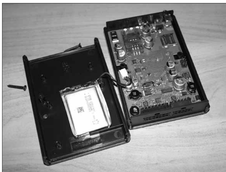
Telekomunikacinis įtaisas, per palydovinį ryšį jungiantis transporto priemonę su transporto bendrovės informaciniu centru
