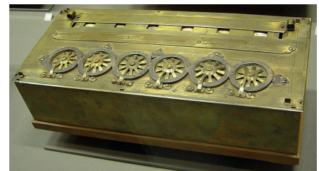
9.13 pav. Blezo Paskalio XVII a. sukurta aritmetinė mašina. Ja buvo galima sudėti ir atimti skaičius.
