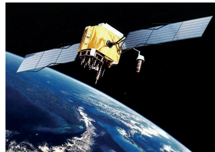
9.10 pav. Vienas iš GPS palydovų, kurių sistema leidžia nustatyti imtuvo, priimančio jų signalus, tikslų padėtį Žemėje.
