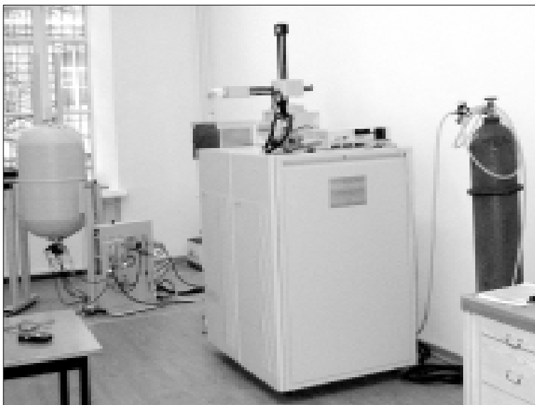
Vilniaus universitetui farmacinės bendrovės „Bristol Meyer Squibbs“ padovanotasis didelės skiriamosios gebos 300 MHz branduolių magnetinio rezonanso spektrometras „Varian“
