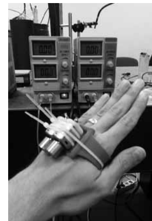
Vibroapyrankė, kuri virpesiais aktyvina galūnių kapiliarus (žmogaus „antroji širdis“), taip skatindama žmogaus kraujotaką ir širdies darbo sutrikimo atvejais užtikrindama gyvybinių organų, tokių kaip žmogaus smegenys, aprūpinimą krauju
