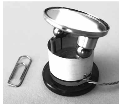
Didelės kampinės skyros lazerio spindulio deflektoriaus nuotrauka ir schema: 1 – veidrodys, 2 – pastovus cilindro formos magnetas, 3 – feromagnetinė sfera, 4 – pjezoelektrinis cilindras su sekcionuotais elektrodais
