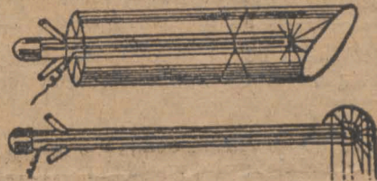
Lampy lecznicze d-ra Laidmana. Promienie ultrafioletowe otrzymują się z iskry elektrycznej i są zebrane za pomocą reflektora.
