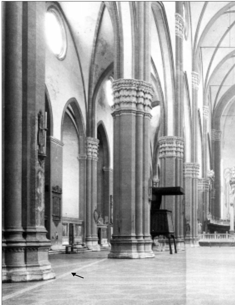
Astronominis instrumentas gnomonas Sant Petronio katedroje Bolonijoje, iki Grigaliaus XIII kalendoriaus reformos naudotas kalendoriniams skaičiavimams; rodykle pažymėtas gnomono meridianas
