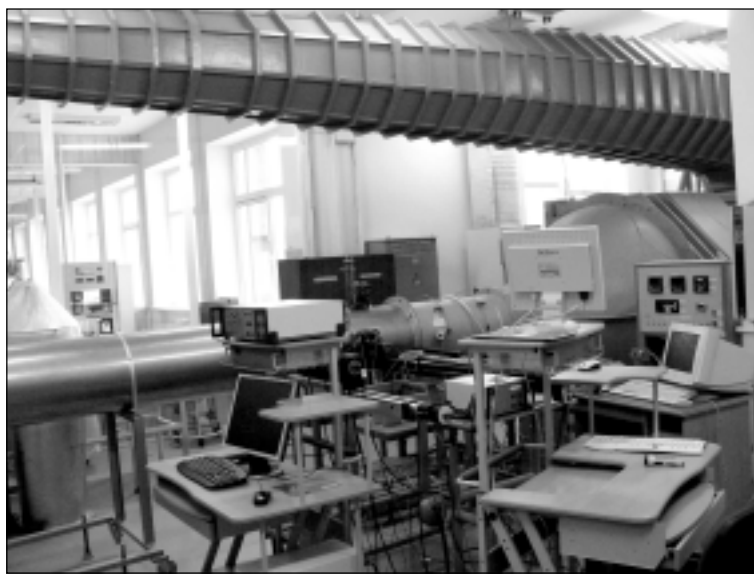
Energetikos instituto Šiluminių įrengimų tyrimo ir bandymų laboratorijoje oro greičio matavimo tyrimų aparatai
