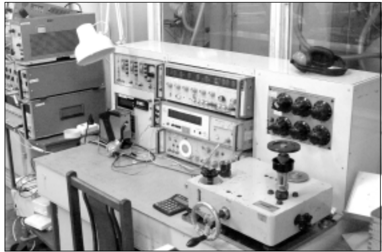
Įrangos kompleksas dujų ir garo matuoklių skaičiuotuvų aparatūrinei ir programinei įrangai tirti bei bandyti
