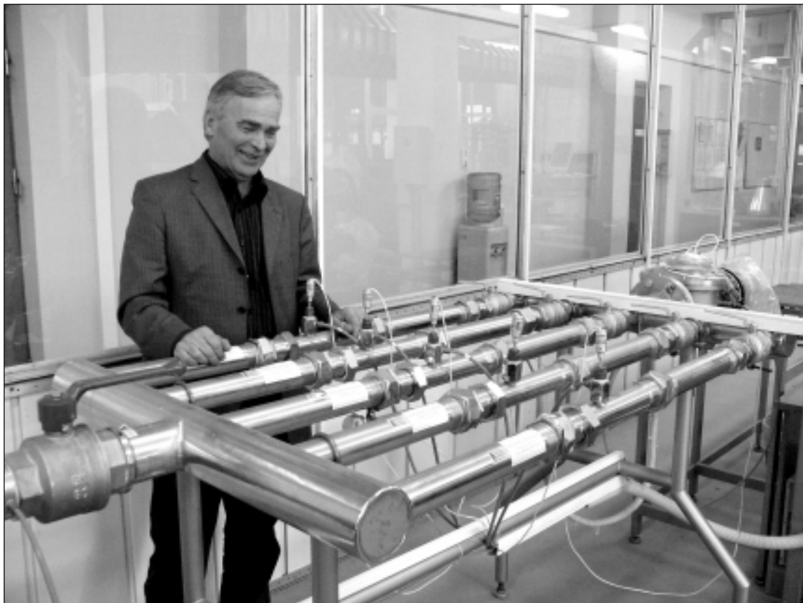
Laboratorijos vadovas Antanas Pedišius prie kritinių tūčių įrenginio, kuriame atkuriamos oro (dujų) tūrio ir debito iki 300 m 3 /h vienetų vertės taikant kritinio tekėjimo dėsningumus. Šis įrenginys yra valstybės etalono viena iš sudedamųjų dalių
