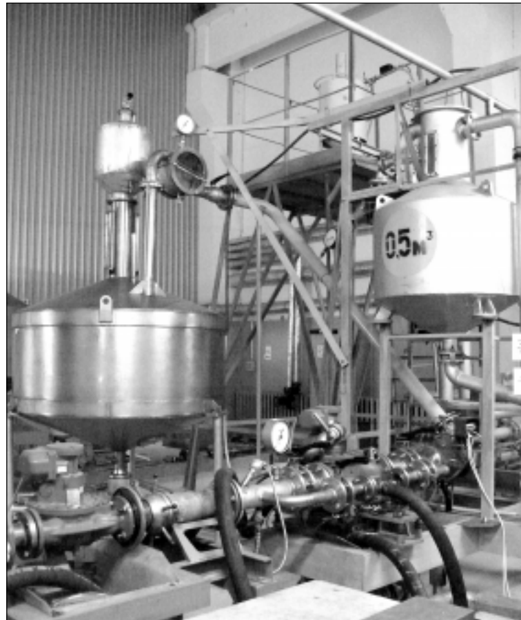
Įrenginio, skirto lengvųjų naftos produktų tūrio ir debito iki 120 m 3 /h vienetų vertėms atkurti ir jų matuokliams tirti, bandyti ir kalibruoti, fragmentas. Įrenginyje realizuojami tūrinis, reikalui esant, ir gravimetrinis pertekkančio skystųjų produktų kiekio matavimo metodai
