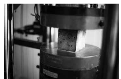
Naujojo betono stiprumo tyrimas. KTU nuotr.
