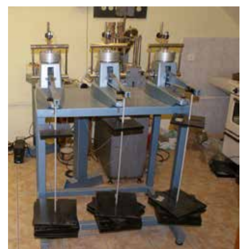
Gruntų mechanikos laboratorija. Odometrinis prietaisas, skirtas deformaciniams gruntų savybėms tirti. (2021 m., sausis). S. Gadeikio nuotr.
