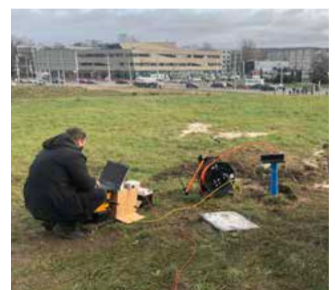
Geofiziniai seisminiai tyrimai gręžinyje (Vilnius, Kareivių g., 2022 m.) S. Gadeikio nuotr.
