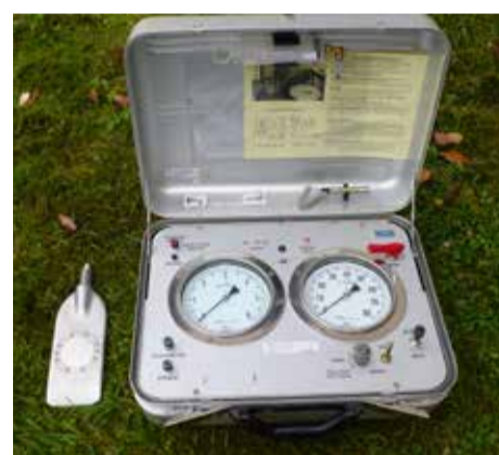
Dilatometras – lauko prietaisas gruntų deformacinių savybių tyrimams (2020 m., Kairėnai) S. Gadeikio nuotr.
