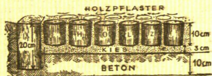
Schema der Holzplasterung
