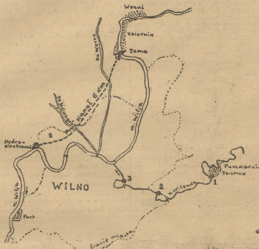
Na szkicu uwidocznił jest kanał w drugim wariantcie linii przerywaną. Małe hydroelektrownie na Wilence oznaczone są kółkami i ponumerowane w kolejności ich ew. budowy. Zaznaczony jest także port na Wilii według projektu miejskiego biura urbanistycznego.
