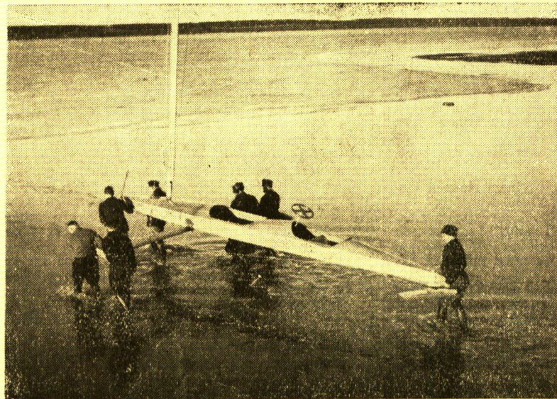
Links: Der Segelschlitten wird vom Ufer durch das Aufwasser auf das Eis getragen. Die Aufnahme, die vom Tafelmaß aus gemacht worden ist, zeigt deutlich die Konstruktion und die Einzelheiten einer modernen Eisnacht: im vordersten Drittel kreuzt den schmittigen Schlittenkörper im rechten Winkel die Läuferplanke, die rechts und links Vrongeleusen führt. Die dritte Luke sitzt im Deck und folgt den Drahtseilen, die von dem im „Kodpit“ befindlichen und auf dem Bild deutlich sichtbaren Mastseil gezogen werden. Vor dem „Kodpit“ befindet sich die „Passagierkabine“, in der ein und, wenn es not tut, auch zwei Begleiter Platz haben. Rechts: Der Schlitten wird zur Fahrt klargemacht.
